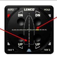
HORIZONTAL LEDS ON THE CROSSHAIR SHOW YOU THAT THE CURRENT ROLL POSITION OF YOUR BOAT IS ROLLED TO STARBOARD IN REFERENCE TO THE AUTO GLIDE'S HOME ROLL DEFAULT POSITION.
