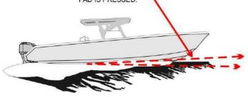
THE CURRENT ROLL POSITION WILL ALSO ROLL TO THE STARBOARD OF THE HOME ROLL POSITION WHEN THE STARBOARD DN BUTTON ON THE KEY PAD IS PRESSED.
